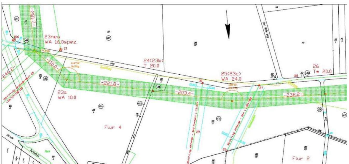
Abbildung 10: Leitungsverlauf der 110 kV Freileitung und Maststandort 23 (Quelle: Westfalen Weser Netz GmbH, ohne Maßstab)
