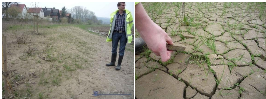
Abbildung 33: Vorlandaufhöhung nach einem Winterhochwasser durch mitgeführtes Sediment der Emmer in Wöbbel
