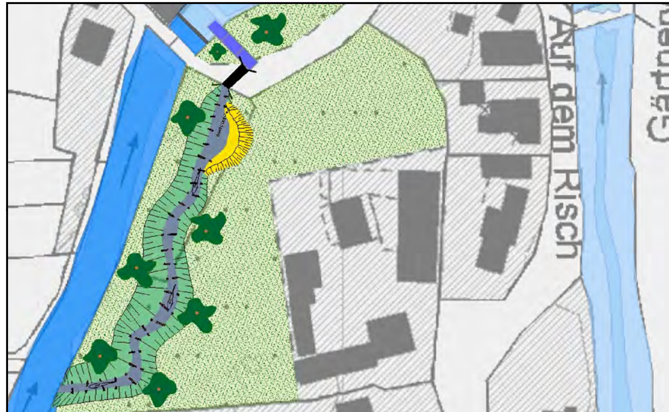
Umgehungsfluss und Schlitzpass "FAA Mühle Neudorf" gemäß DWA-M 509
